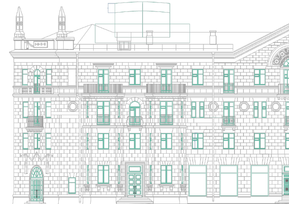
Рисунок 6. Геометрические параметры фасадов здания по ул. Свердлова, 22 на основе фотограмметрической обработки архивных фотоснимков. Определение пропорций рекламного элемента надкрышной рекламой.
