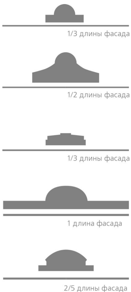
Схема № 1. Характерные формы надкрышных конструкций
